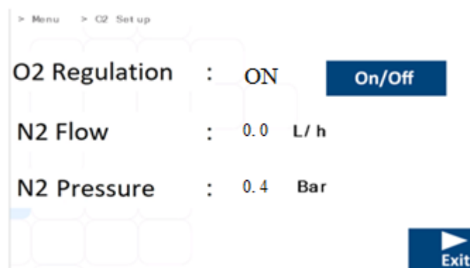
Joonis 13.26 MIRI® TL6 ja MIRI® TL12 mitmekambrilise kehavälise viljastamise inkubaatori O 2 seadistuse alammenüü vaade
