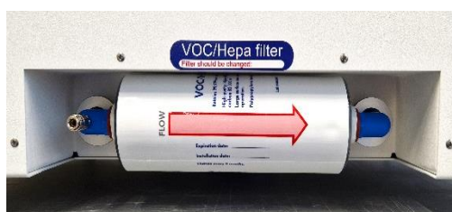
Joonis 12.3 Õigesti paigaldatud VOC/HEPA filter
