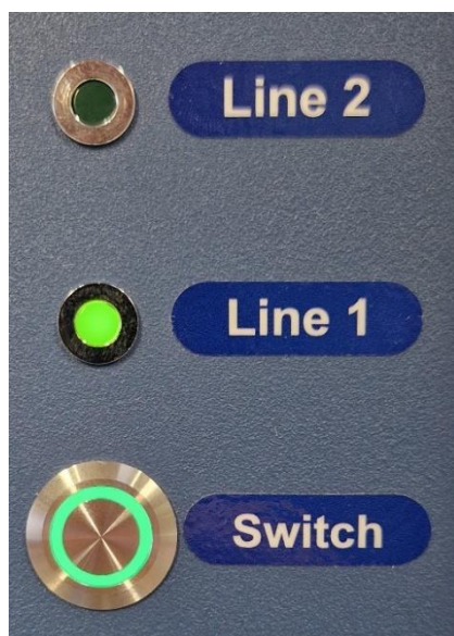
Joonis 20.2 MIRI® TL12 mitmekambrilise kehavälise viljastamise inkubaatori liini muutmise lüliti ja aktiivne liin 1
