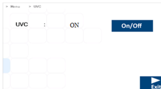
Joonis 13.28 MIRI®TL6 ja MIRI® TL12 mitmekambrilise kehavälise viljastamise inkubaatori UV-C-valguse reguleerimine.
