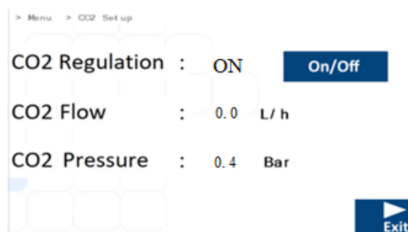
Joonis 16.2 MIRI® TL6 ja MIRI® TL12 mitmekambrilise kehavälise viljastamise inkubaatori CO 2 seadistuse alammenüü vaade
